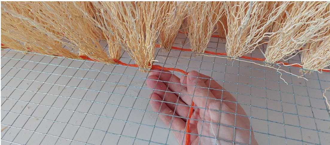
Figur 4. Tillverkning av risvasar. Ett snöre förs upp som en ögla genom metallgallret med jämna mellanrum, och ett litet knippe risrötter sticks in i ögla och kläms ner i metallgallret. Då snöret dras åt hålls risrotsknippen på plats.
