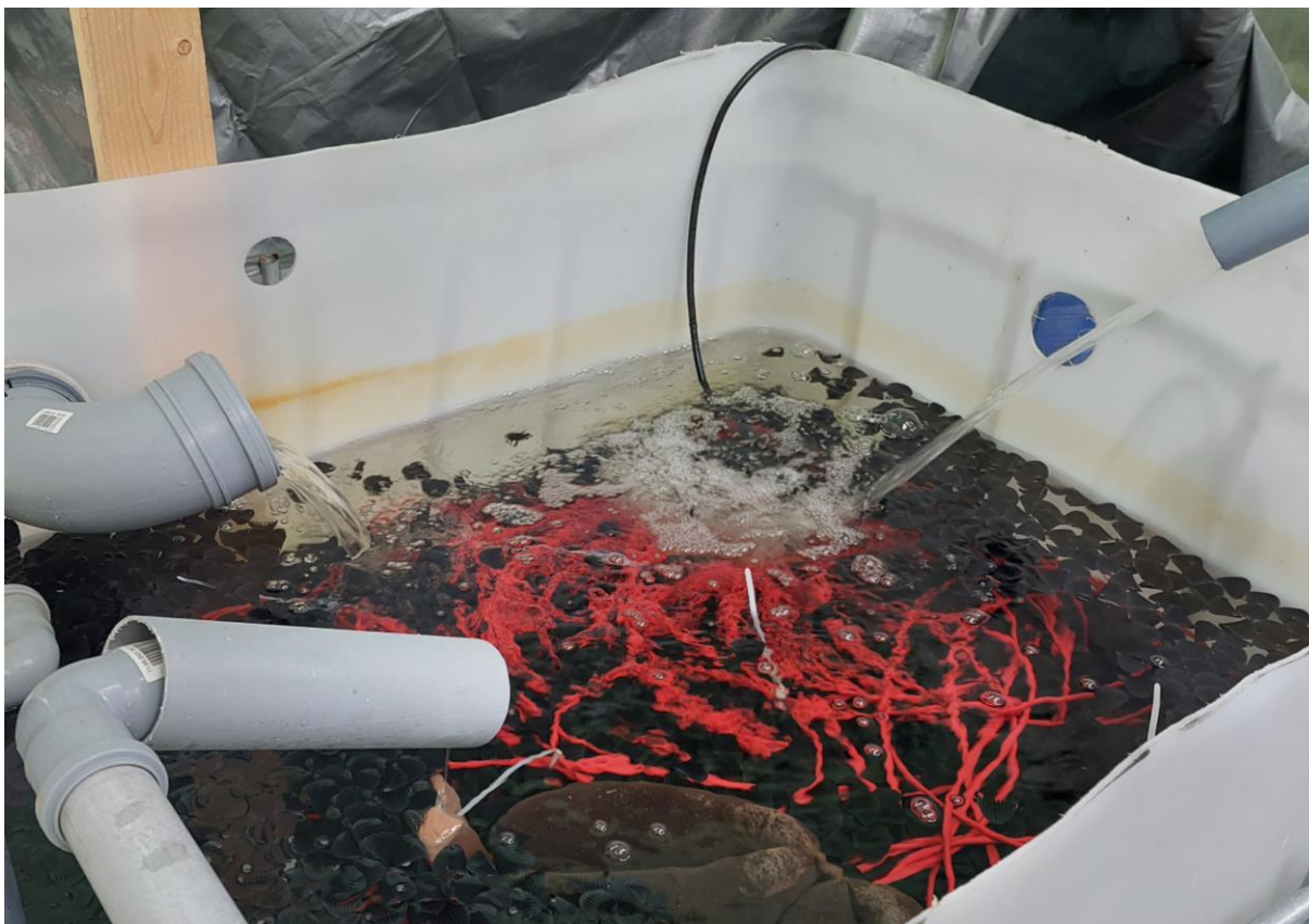
Figur 17. Biofiltertanken med värmeslingan installerad. Nertill syns även strumpbyxan fylld med mylla (för att gynna bakterierna). Röret uppe till höger är överflödesröret från luftningstanken, till vänster syns bassängernas stora utloppsrör, och längst mot kameran finns röret från brunnsvattentanken. Detta rör förseddes med en förlängning i ändan för att rikta intaget av nytt vatten längre bort från överflödesröret som för vatten bort till avloppet (delvis synligt till vänster). Röret var dessutom försett med hål borrade undertill.
