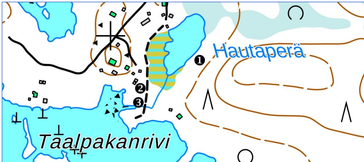
Figur 3.22. Gloet vid Hautaperä (1) med ny villaväg (2) och fel anlagd vägtrumma (3) (kartan innehåller data från Lantmäteriverkets Terrängdatabas 8/2021).
